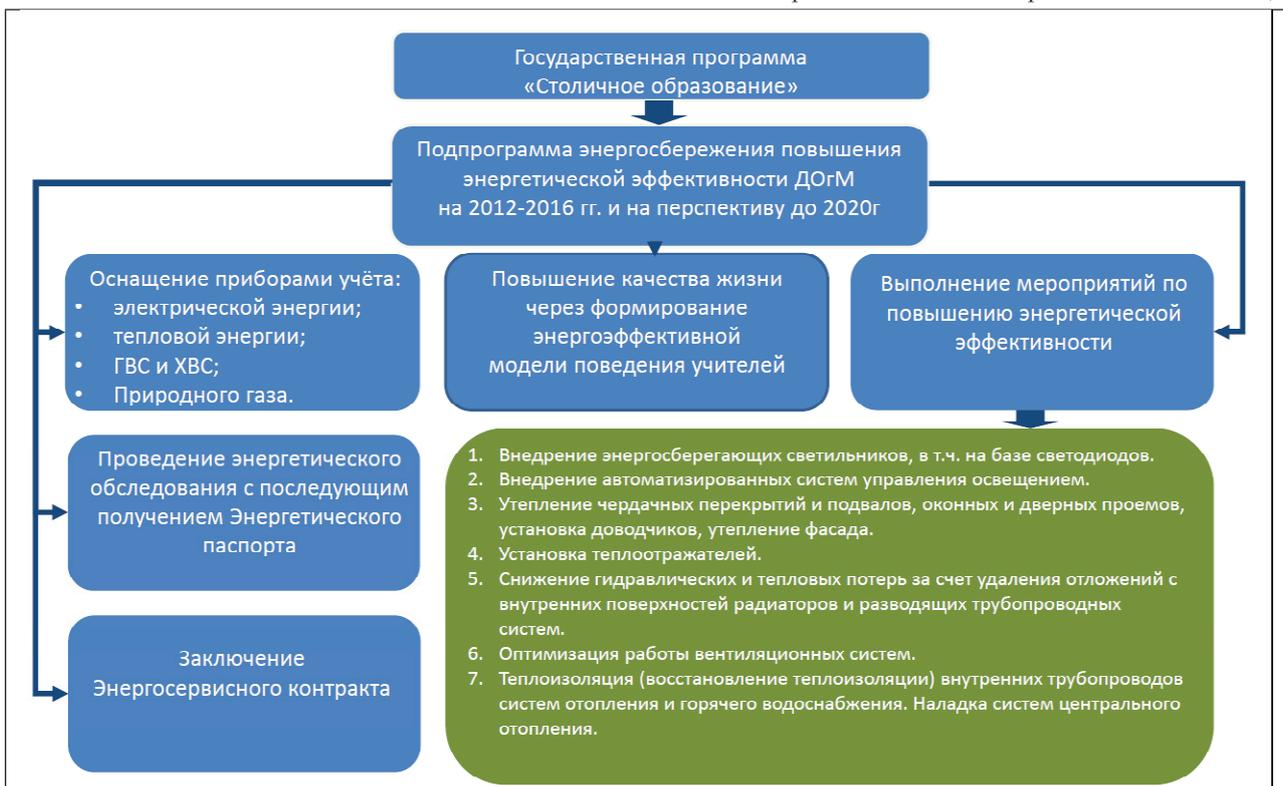
Рис. 1. Структура программ, направленных на повышение энергетической эффективности зданий учреждений
